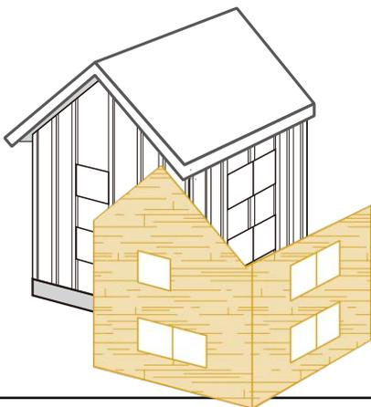
今の外壁材の上に、新しい外壁材を張ります
